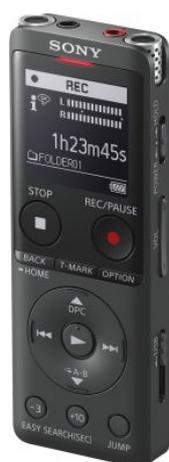
Dictaphone numérique, mémoire 4.000 MB intégrés, enregistrement à commande vocale, restitution MP3, Slot intégré pour carte micro-SD, prise microphone, casque/écouteur, sacoche, câble USB
